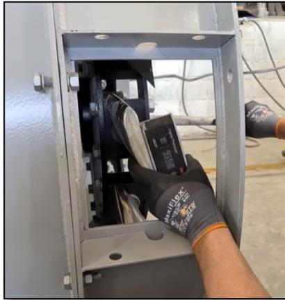
As pás podem ser acessadas pela janela de inspeção para conferência e ajuste do ângulo, verificado na ponta da pá.
