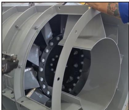
Desmontar o rotor através da janela de inspeção.
