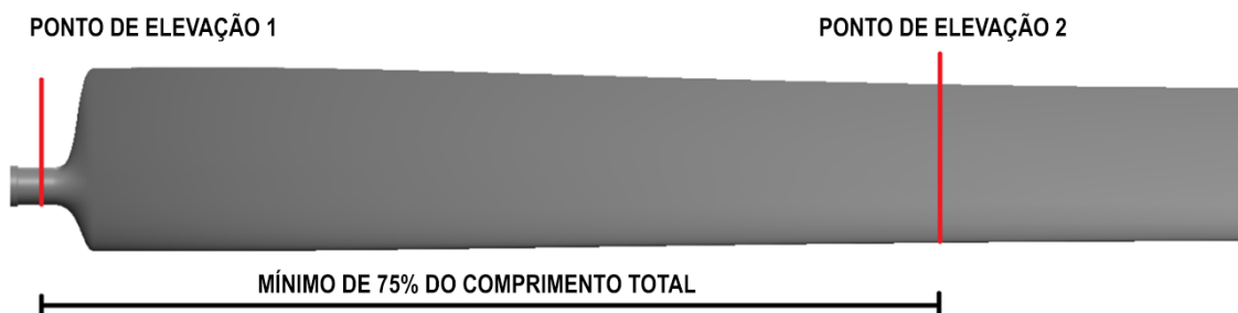
Figura 8 - Pontos de elevação da pá
