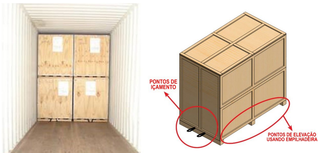
Figura 5 - Fixação de embalagens de madeira/ pontos de içamento
