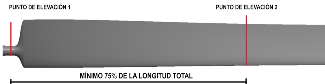
Figura 8 - Puntos de elevación de las aspas
