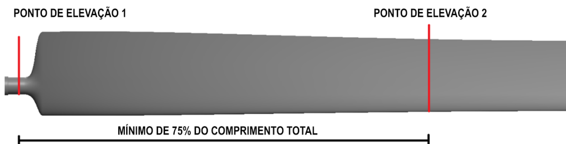
Figura 9 - Pontos de elevação da pá
