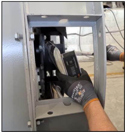
Se puede acceder a las palas a través de la ventana de inspección para verificar y ajustar el ángulo, verificado en la punta de la pala.
