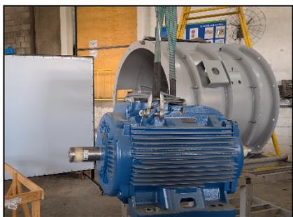
Utilizar ojales en el motor para manipularlo
