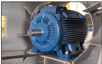
El motor debe ser retirado utilizando ojal de sustentación o por medio del empleo de carretilla elevadora.
