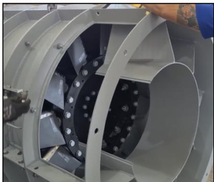
Desmontar el rotor a través de la ventana de inspección.
